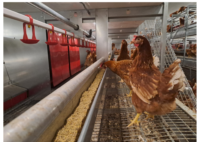
Abbildung 27: Nippeltränken und Kettenfütterung für Legehennen (© Steiner Automation GmbH & Co KG)
