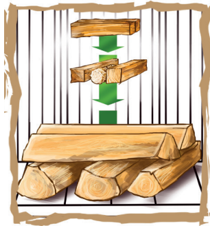
Befuerungselement auf dem Scheitholz positionieren
