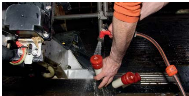
Bild 20: Mehrmals pro Tag sollte man den Melkplatz kontrollieren und Laser, Kamera und Melkzeug reinigen. LK NÖ/Pöchlauer-Kozel
