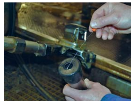
Bild 17: Tupferproben helfen Keimquellen zu finden. LK 00
