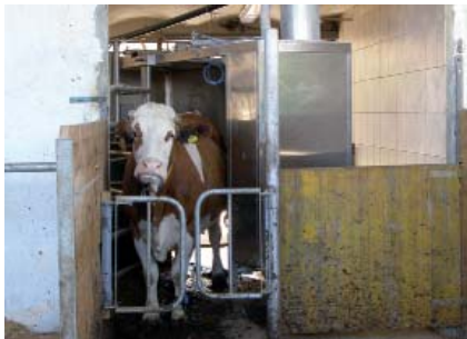
Bild 8: Zu knappes Westerntor am Austrieb – der Roboter- ausgang kann dadurch von Kühen blockiert werden. LK OÖ/Fruhstorfer
