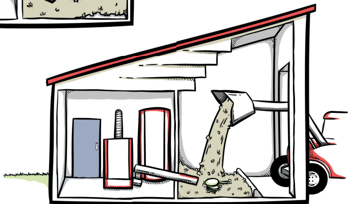
Heizhaus ebenerdig: Die Lagerräumbefüllung erfolgt direkt vom Hacker bzw. vom Traktor mit Frontlader.
