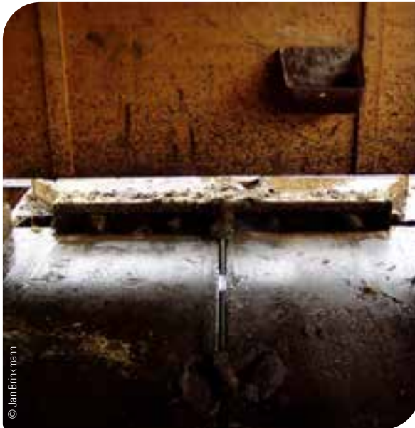
Abb. 62: Entmistungsschieber im Ruhezustand außerhalb des Tierbereichs
