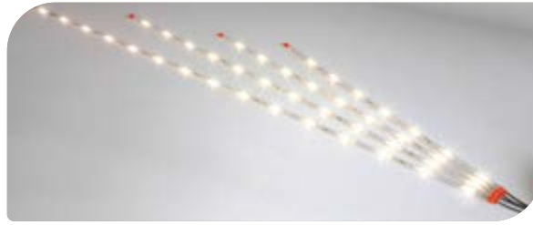
Abb. 75 b: FlexLED Hauptlicht und Anlagenlicht
