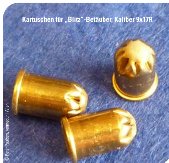
Abb. 5: Munition für Bolzenschussgeräte Bauart „Blitz“
