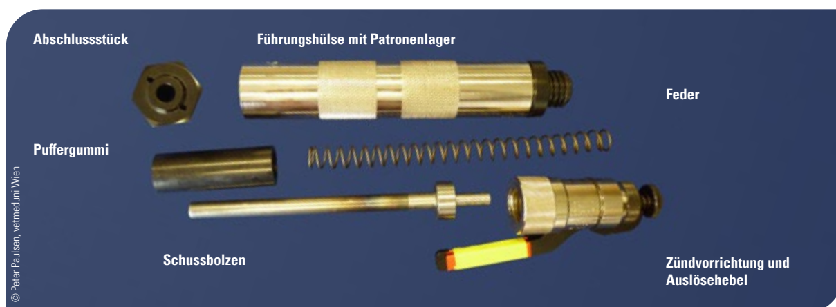
Abb. 4: Für Reinigungszwecke zerlegtes Bolzenschussgerät der Bauart „Blitz“
