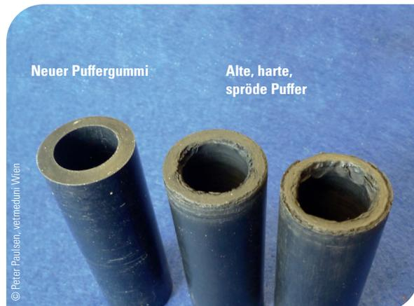
**Abb. 10:** Alte Gummipuffer müssen ausgetauscht werden
