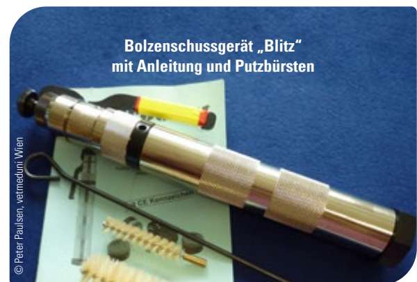
Abb. 6: Bolzenschussgerät Bauart „Blitz“ in ordentlichem Wartungszustand
