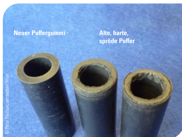
Abb. 10: Alte Gummipuffer müssen ausgetauscht werden
