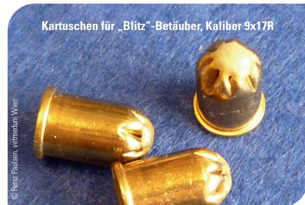
Abb. 5: Munition für Bolzenschussgeräte Bauart "Blitz"
