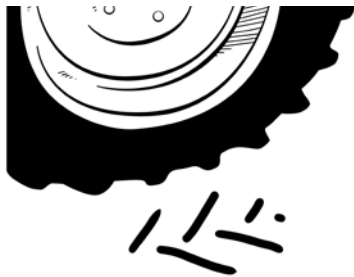
1,6 bar Reifendruck = 2.050 cm 2 Bodenkontakt
