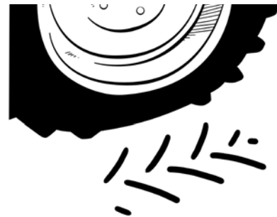
0,8 bar Reifendruck = 4.200 cm 2 Bodenkontakt
