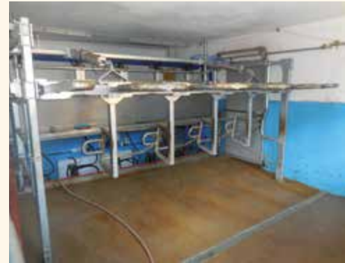
Platzsparender, einfacher Side-by-side Melkstand
