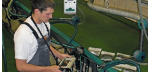
Foto 6: Pulsatorprüfung von geschulten Technikern durchführen lassen.
