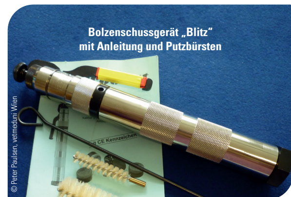
Abb. 6: Bolzenschussgerät Bauart „Blitz“ in ordentlichem Wartungszustand
