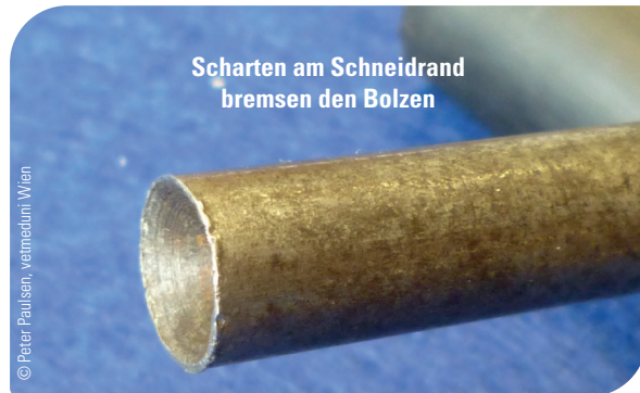
Abb. 9: Scharten am Schneidrand des Bolzens führen dazu, dass der Bolzen im Gehäuse reibt oder steckt
